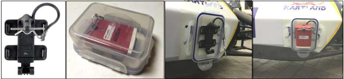
그림19. 트랜스폰더 설치 위치 및 형상 예시
