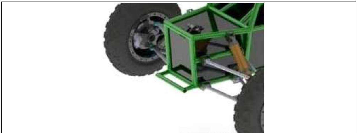
그림12. 견인 고리 형태 및 부착방법
